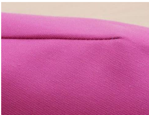
49-rasm. Noto'g'ri qilingan vitochka
