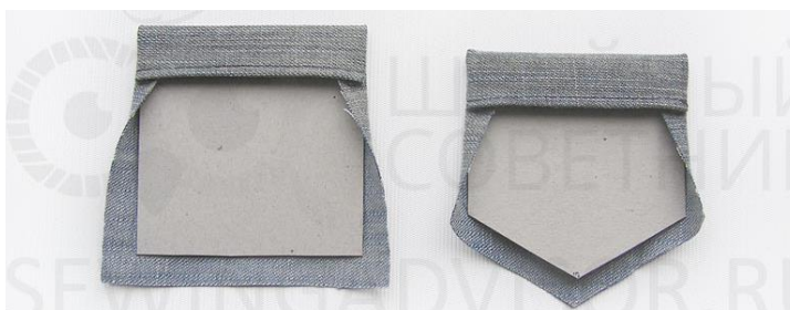
80-rasm: Shablони yuqori chekka ostiga qo'yib, mos qismlarni qirqish
