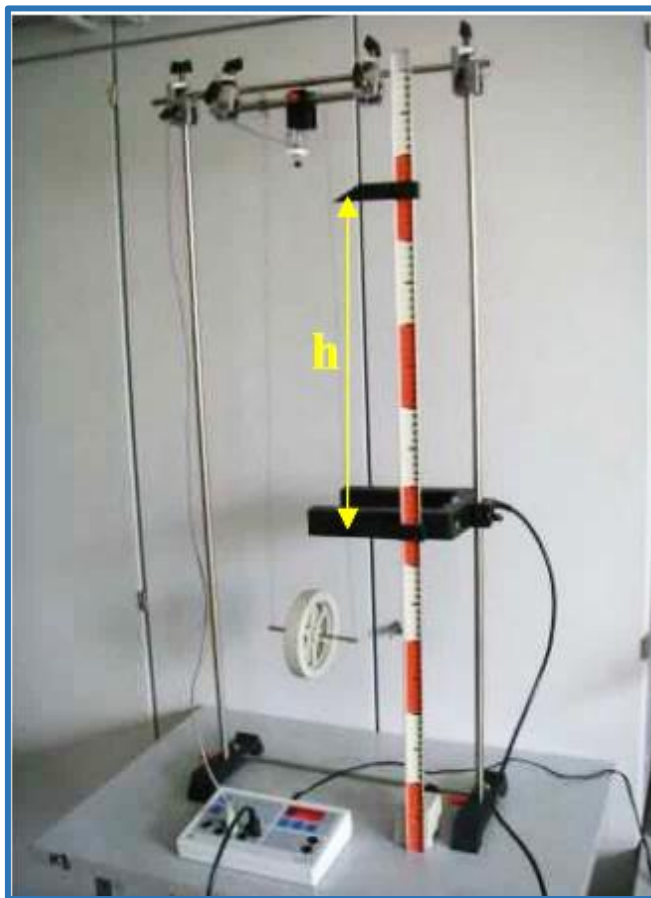
1-rasm. Maksvell disklari yordamida energiya saqlanishi qonunini tekshirish uchun mo'ljallangan tajriba qurilmasi.
